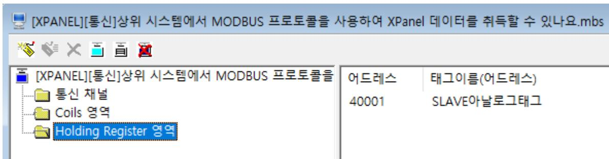
MODBUS Slave 메모리는 Coil, Holding Register 영역으로 구성되어 있으며, Coil 영역에는 디지털 태그를, Holding Register 영역에는 아날로그/문자열 태그를 등록하여 사용할 수 있습니다.
